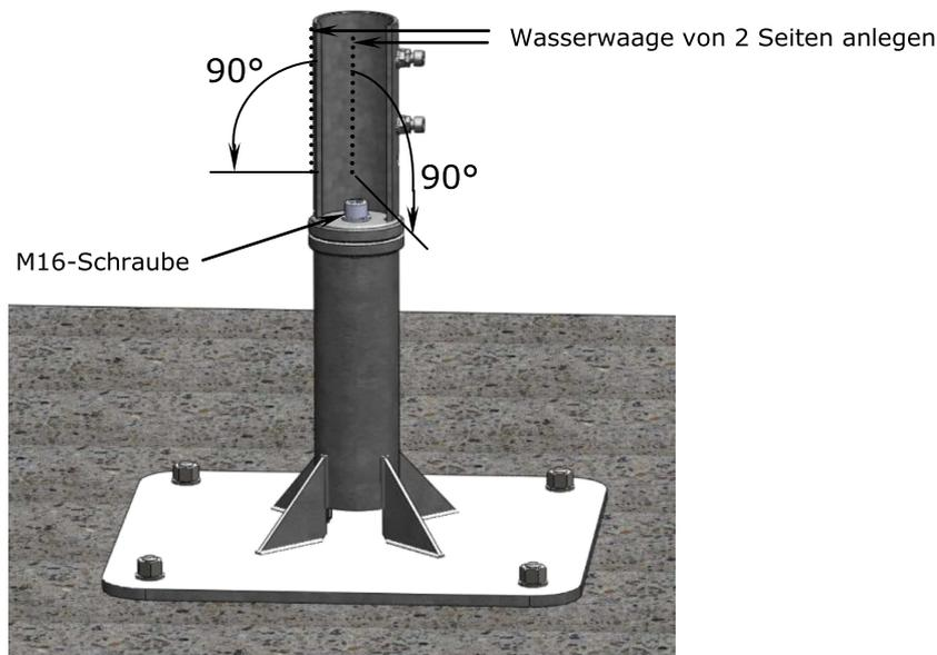
3. Richten Sie die SZ129 / SZ029 so aus, dass die Grundplatte des Unterteils korrekt mit der Oberkante des Terrassenbodens abschließt.
