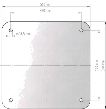
2. Verschrauben Sie die Ankerplatte auf das Betonfundament. Bei Schwerlast-Ankerbolzen Ihrer Wahl befolgen Sie die Hinweise des Herstellers. Von der Firma MAY gelieferte Schwerlast-Ankerbolzen werden wie folgt angebracht.
