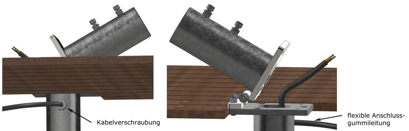
2. Verbinden Sie die Anschlussgummileitung und die Stromversorgung für den Sonnenschirm wasserdicht. Die Anschlussgummileitung (bei Starkstrom: min. 5-polig, min. 4mm<sup>2</sup> Leitungsquerschnitt) muss passend zu Verbrauchern und Zuleitungslänge von einem Elektrofachmann ausgelegt werden.
